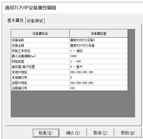
图 15.11-2 设置父设备参数
