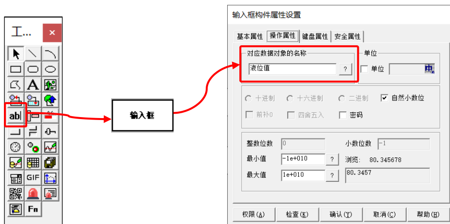
3.2-5 输入框关联变量流程图
