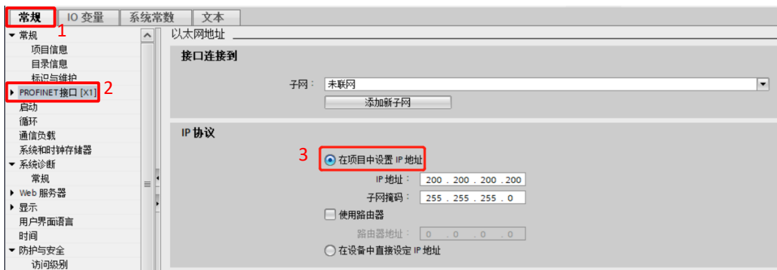
图 15.11-9 设置 PLC 参数一
