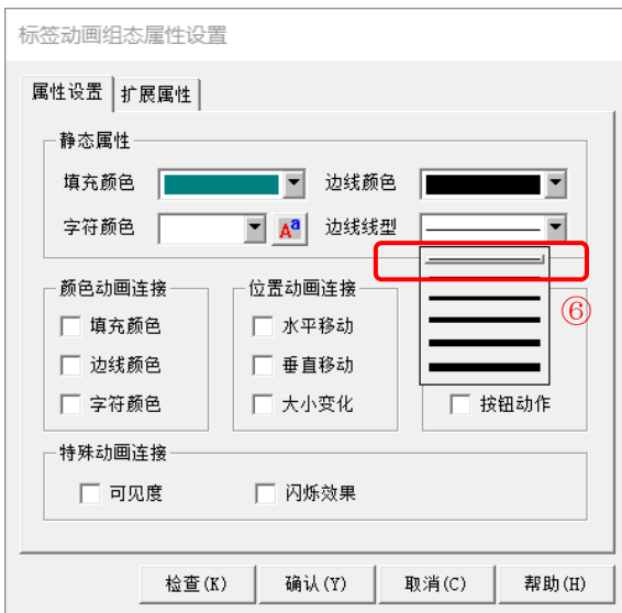
图 3.5-21 设置标签边线线型
