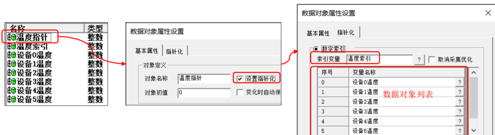
图 7.2-2 数字索引指针变量-设置流程图
