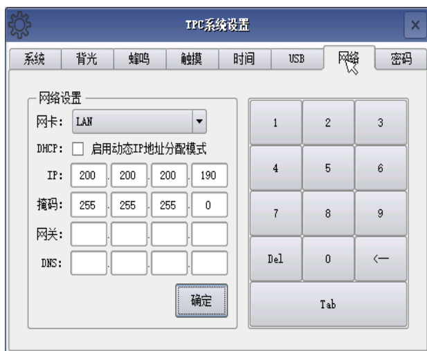
图 15.5-8 设置 TCP/IP 地址
