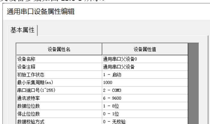
图 15.6-3 设置父设备参数
