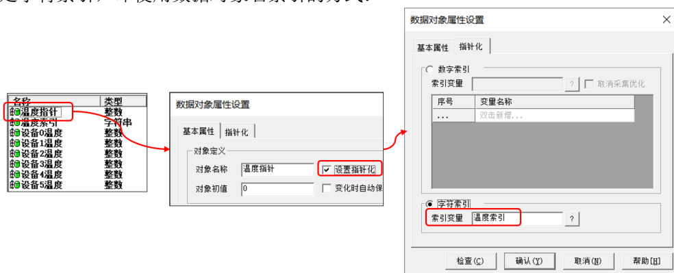
图 7.2-4 字符索引指针变量-设置流程图
