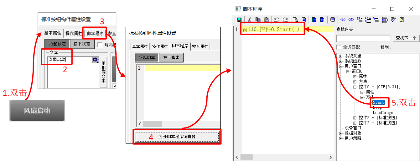
图 3.5-2 构件方法设置流程图
