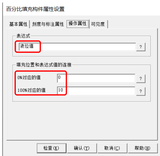
图 3.5-27 设置百分比填充构件操作属性
