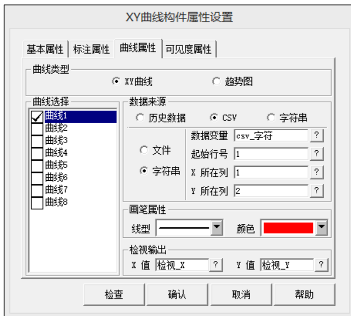
图 9.2-6 数据来源为 XY 曲线_CSV_字符串
