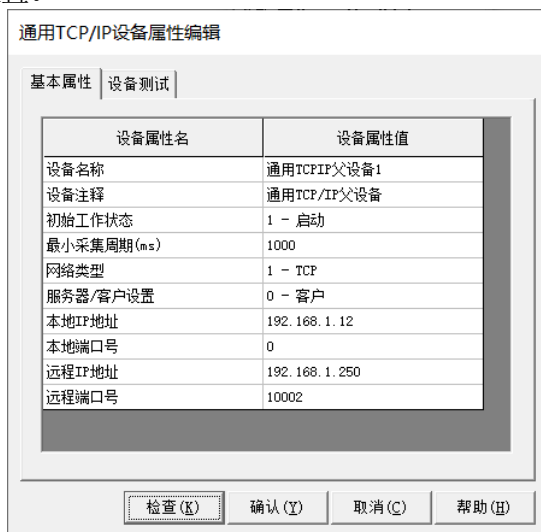
图 15.7-12 按新 PLC 设置新父设备参数
