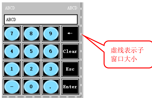
图 2.3-14 子窗口模式打开自定义键盘
