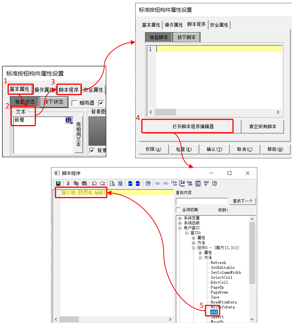
图 8.2-6 配方构件方法函数
