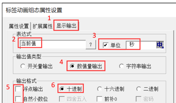
图 11.11-9 标签构件显示属性设置
