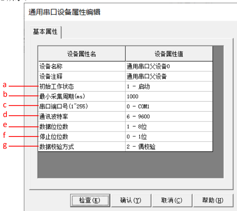
图 15.2-1 通用串口设备属性编辑界面
