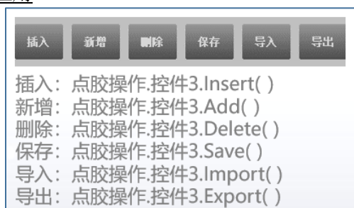
图 8.4-23 组态配方构件方法函数
