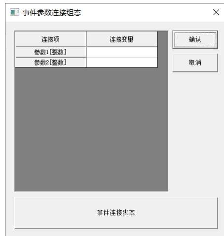
3.6-6 KeyDown 事件参数连接组态对话框
