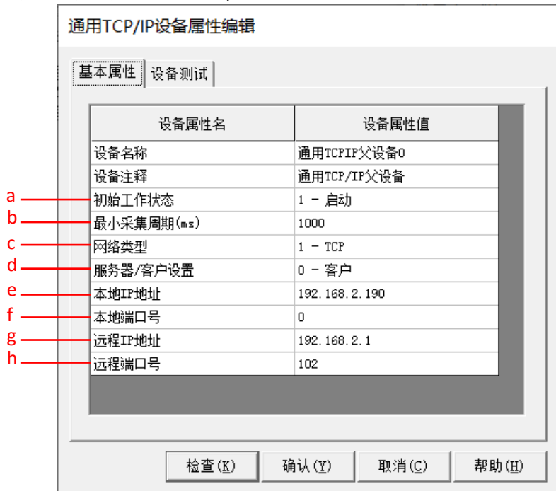
图 15.2-2 通用 TCP/IP 父设备编辑界面
