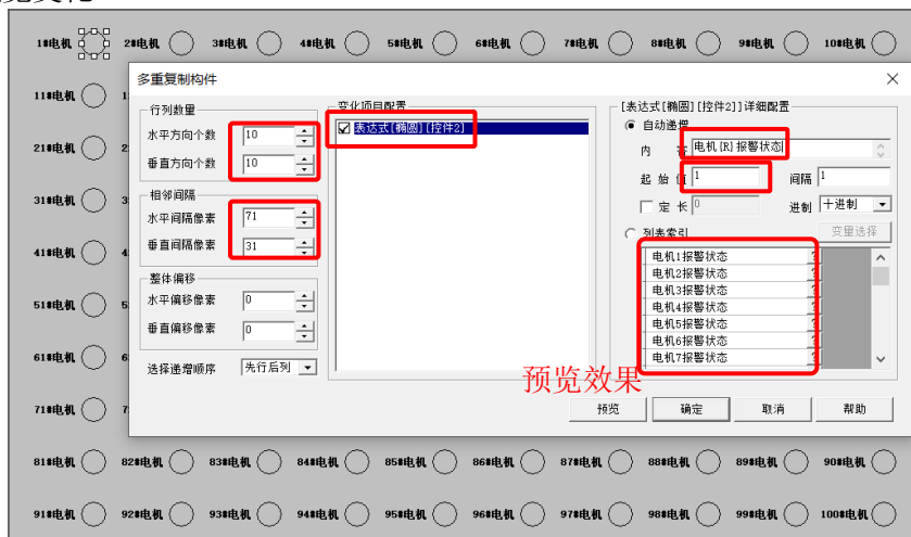
图 6.1-6 对椭圆图元进行多重复制
