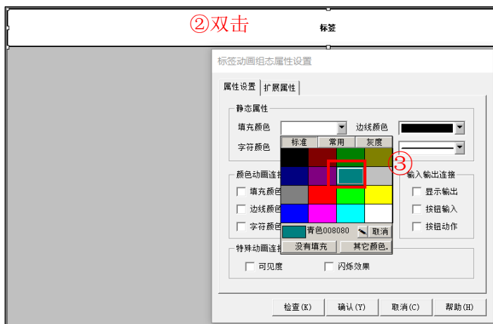
图 3.5-19 设置标签填充颜色
