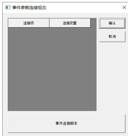
图 3.6-8 Change 事件参数连接组态对话框
