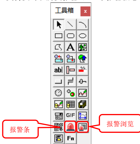
图 4.1-2 支持报警显示的构件
