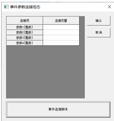
图 3.6-3 MouseDown 事件参数连接组态对话框
